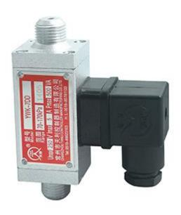
控制器采用膜片及活塞结合形成的传感器,能耐较高的静压,适用于空气、气体等中性气体和润滑油、轻燃油等液体介质。控制器的差压设定值可调,调节范围 70~300KPa。控制器结构紧凑小巧,尤为适用于对安装空间要求苛刻的场合。
