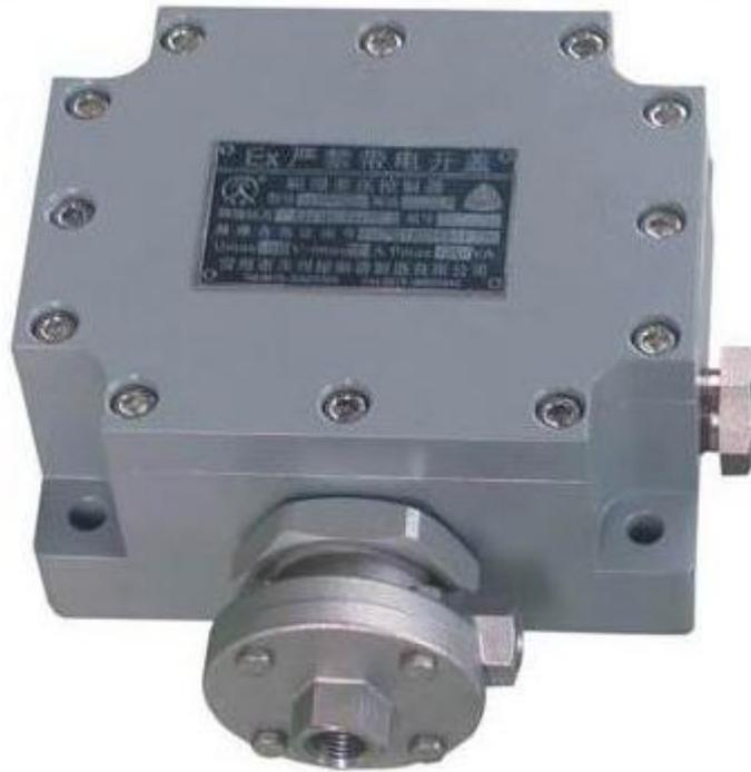
该控制器采用膜片—活塞组合感应，适合从低到高的差压，流体动力或过程应用中的不同静压、过范围的脉冲压力或范围的循环率。可用于空气、气体、油、水和无腐蚀性的介质。
